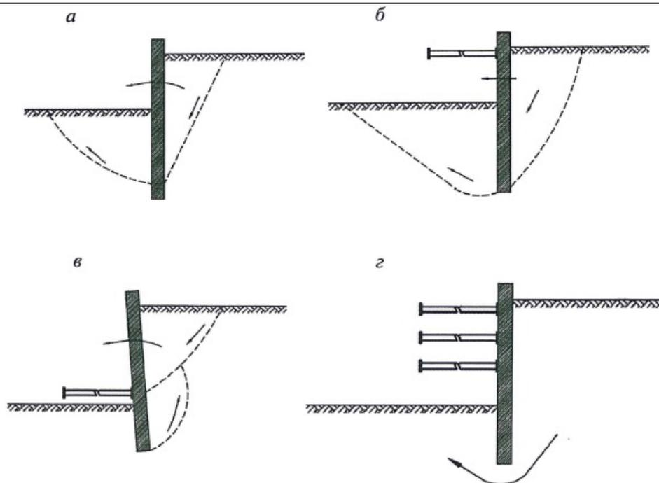
Рисунок 11.2 - Схемы разрушения при недостаточной заделке ограждения котлована
