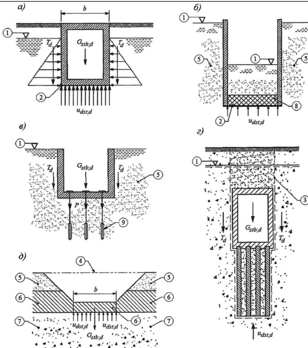
1 - уровень подземных вод; 2 - водонепроницаемая поверхность; 3 - поверхность разрушения; 4 - первоначальный уровень грунта; 5 - песок; 6 - глина; 7 - гравий; 8 - грунтоцемент; 9 - анкер
