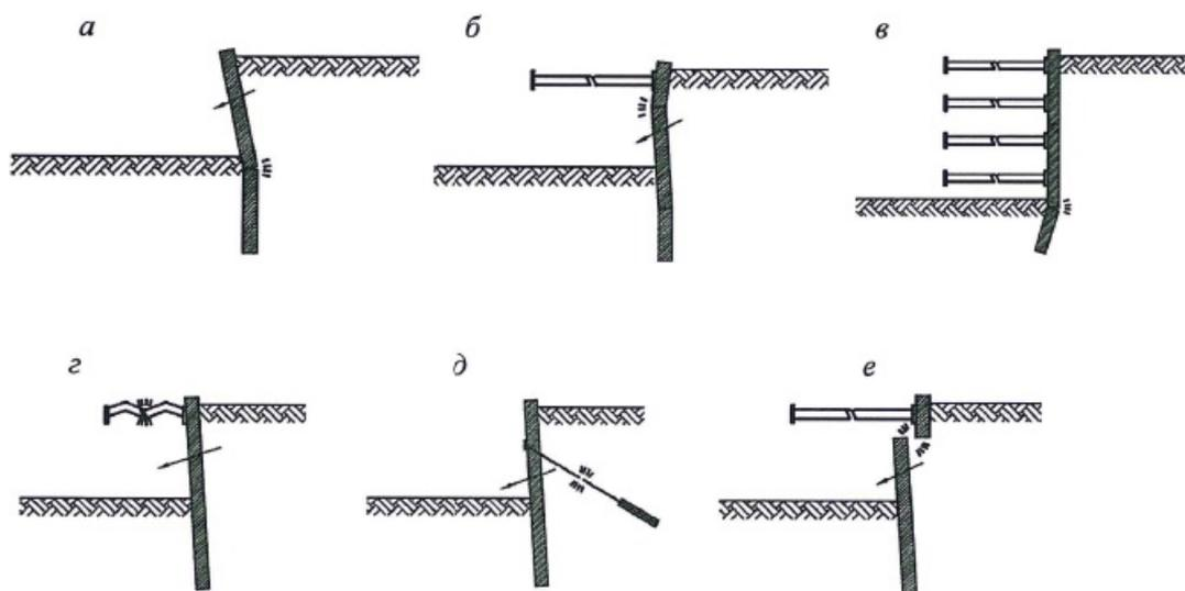
Рисунок 11.3 - Проектные ситуации, соответствующие разрушению конструктивных элементов
